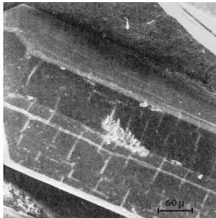
Fig. 5b. Rasterelektronenmikroskopische Aufnahme eines zu \text{Rb}_2\text{MnF}_5 entwässerten Kristalls mit Spalten parallel und quer zur Nadelrichtung
